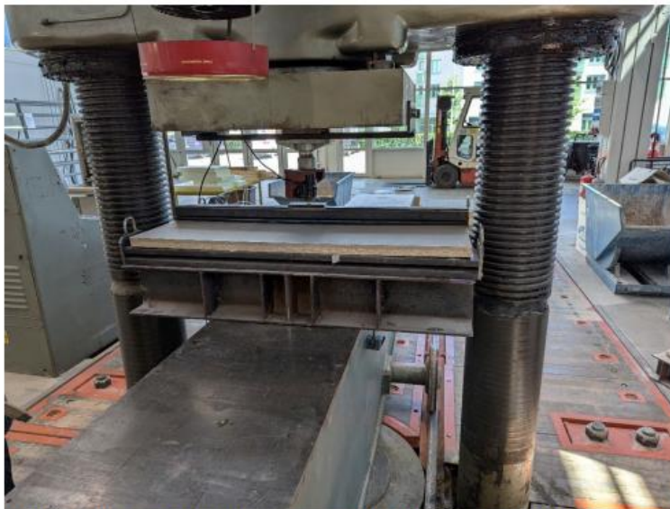
Figur 12: Spånskiva med avjämningsmassa. Notera hur krökt skivan är, detta på grund av krympning i avjämningsmassan.
