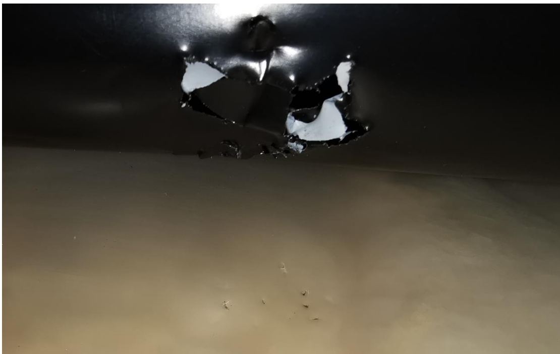
Figur 4:12 Utrymmet mellan yttre emballage och underliggande förstärkningsplast. Hål från fåglar i ovkant av foto och sex stycken deformationer, ej genomgående hål, i den under förstärkningsplasten (Foto: Göran Berggren).
