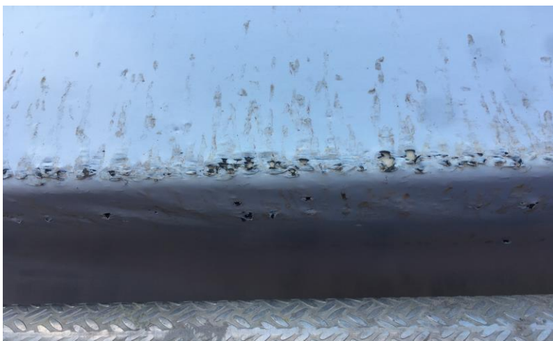
Figur 4:8 Exempel på hål i emballage på kant orsakad av spännband (Foto: Lars Oscarsson).
