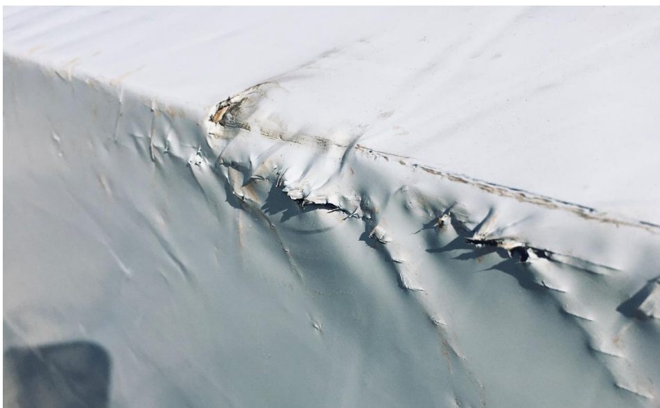
Figur 4:9 Exempel på hål i emballage orsakad av spännband och lyftsling (Foto: Lars Oscarsson).
