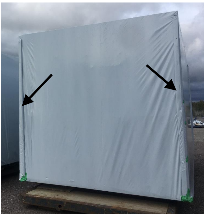
Figur 3:5 Exempel på volym där emballaget efter vikning spänts genom att läkt snurrats in i emballaget (Foto: Göran Berggren).
