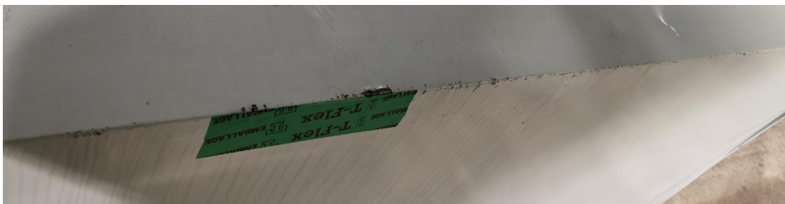
Figur 4:7 Exempel på skrapmärken efter spännband längs långsidornas överkant andra sidan (Foto: Göran Berggren).
