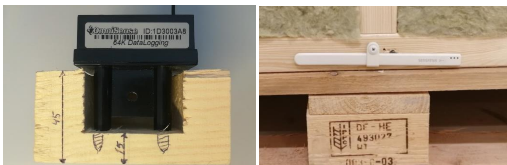
Figur 2:1 Exempel på olika sensorer monterade i och på trämaterial (Foto: Göran Berggren och Lars Oscarsson)
