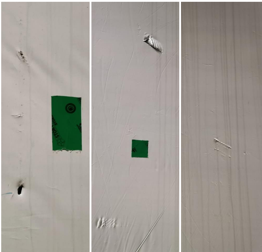
Figur 4:10 Mindre hål kan ses på sidorna av en emballerad modul. Den gröna LDPE-tejp har en bredd av 50 mm och avses utgöra storleksreferens (Foto: Göran Berggren).
