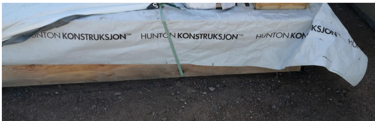
Figur 4:25 Exempel på skada orsakad av smuts och vatten som stänkt upp virkespaket vid kraftigt regn (Foto: S. Olof Mundt-Petersen).
