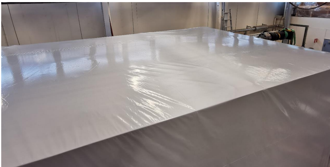
Figur 3:4 Taket på en emballerad modul med "sträckt" emballage (Foto: Göran Berggren).
