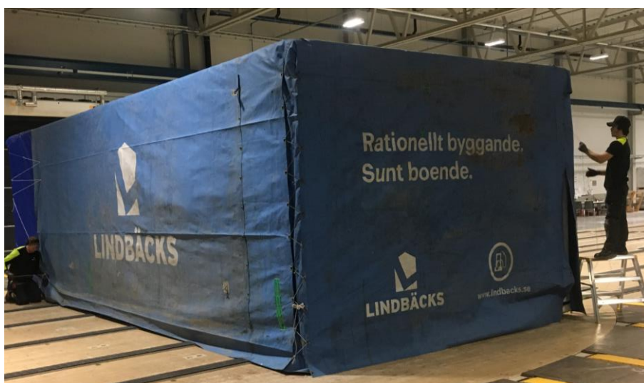
Figur 3:8 Exempel på extra skydd med kapell av tungpresenning utanpå emballerad modul. Extra skydd av tungpresenning ger också bättre förutsättningar för snöröjning på toppen av volymer (Foto: Lars Oscarsson).
