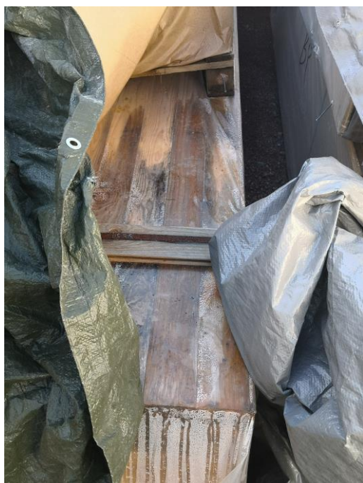
Figur 4:28 Exempel på invändig kondens i helemballerade virkespaket med plywood (Foto: S. Olof Mundt-Petersen).
